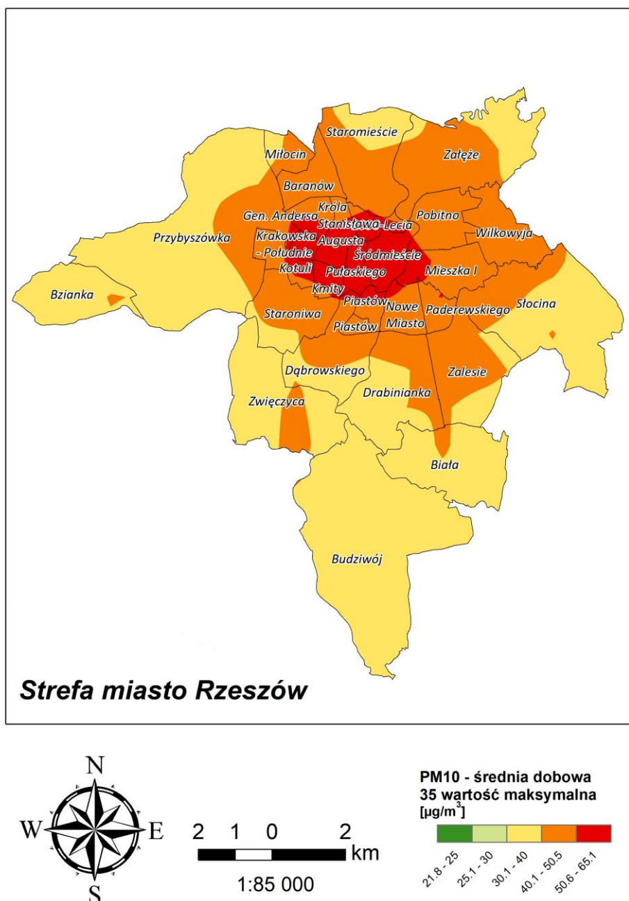
Rysunek 3-1 Rozkłady emisji pyłu zawieszonego PM10 24h (36 max), w strefie miasto Rzeszów, w 2018 r., dla emisji łącznej wszystkich typów
